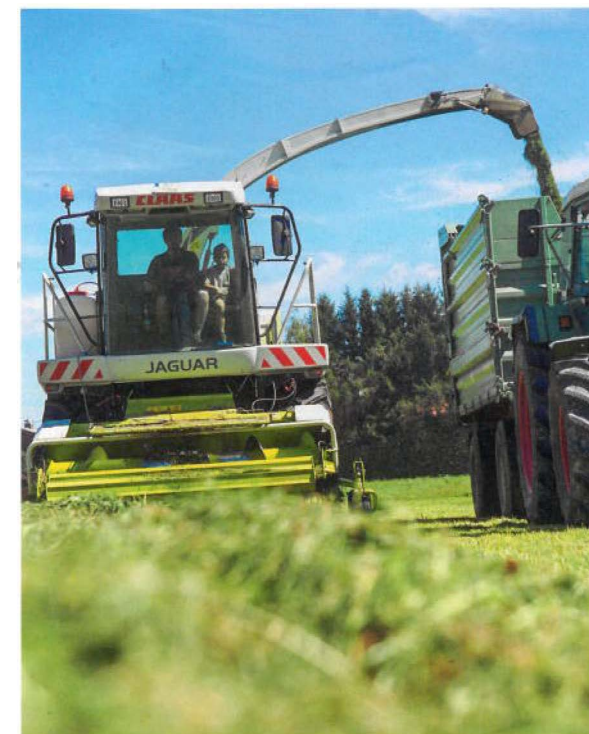
Gras möglichst kurz häckseln: Die Häcksellänge sollte weniger als 2 cm betragen (sofern TM > 30%)
