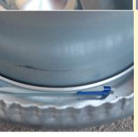
Der Spalt zwischen dem Futterbecken und dem Gefäss darüber sollte beim Expandat oder Mehl nur 1 bis maximal 1.5 cm betragen. Tipp: Ein Kugelschreiber in die Lücke legen zur Kontrolle, ob der Abstand genügend gross ist. Wenn der Spalt, obwohl die Splinte im untersten Loch ist, grösser als 1.5 cm ist, sollte allenfalls noch ein zusätzliches Loch gebohrt werden.
