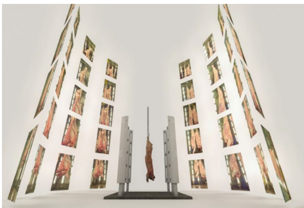
Gerät mit den Kameratürmen für die Klassifizierung in der Mitte. Aussen sind überdimensioniert die Bilder dargestellt, die das Gerät erstellt. Bild: Proviande
